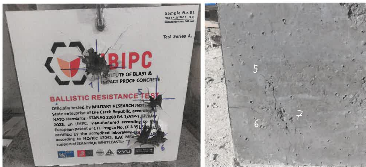
Obr. 3: Terč 01/A: Čelní strana (vlevo) a zadní strana (vpravo) vzorku po střeleckých zkouškách projektilem 7,62 × 54R.
