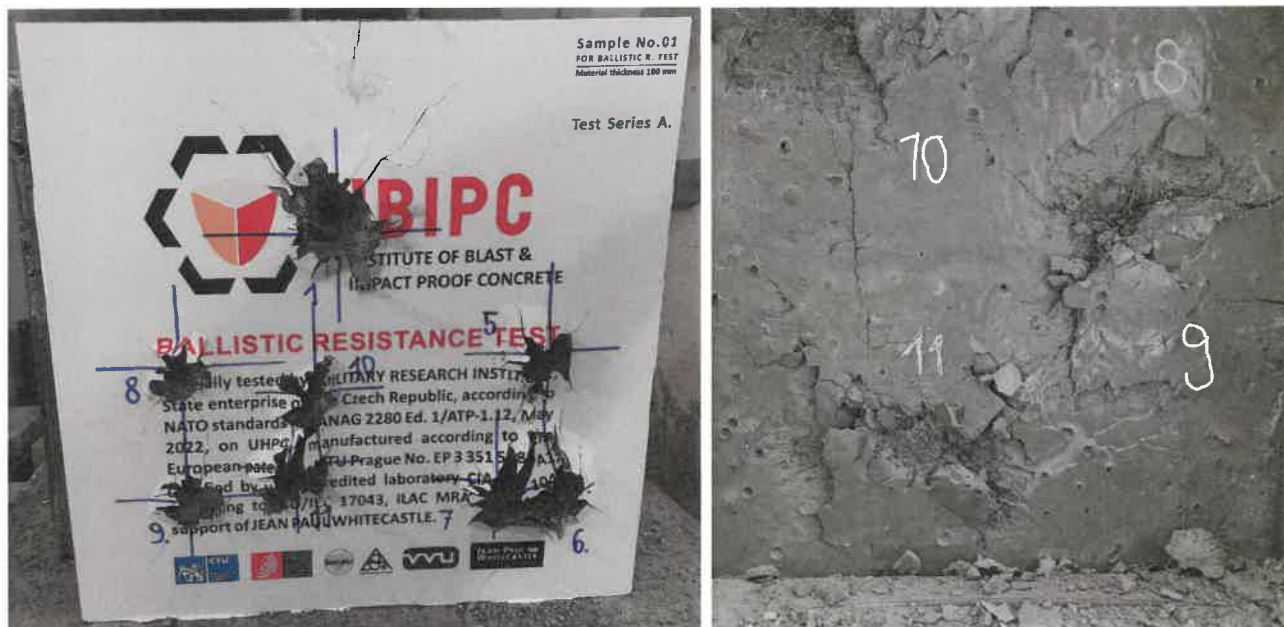
Obr. 4: Terč 01/A: Čelní strana (vlevo) a zadní strana (vpravo) vzorku po střeleckých zkouškách projektilem 7,62 × 51 AP (WC).
