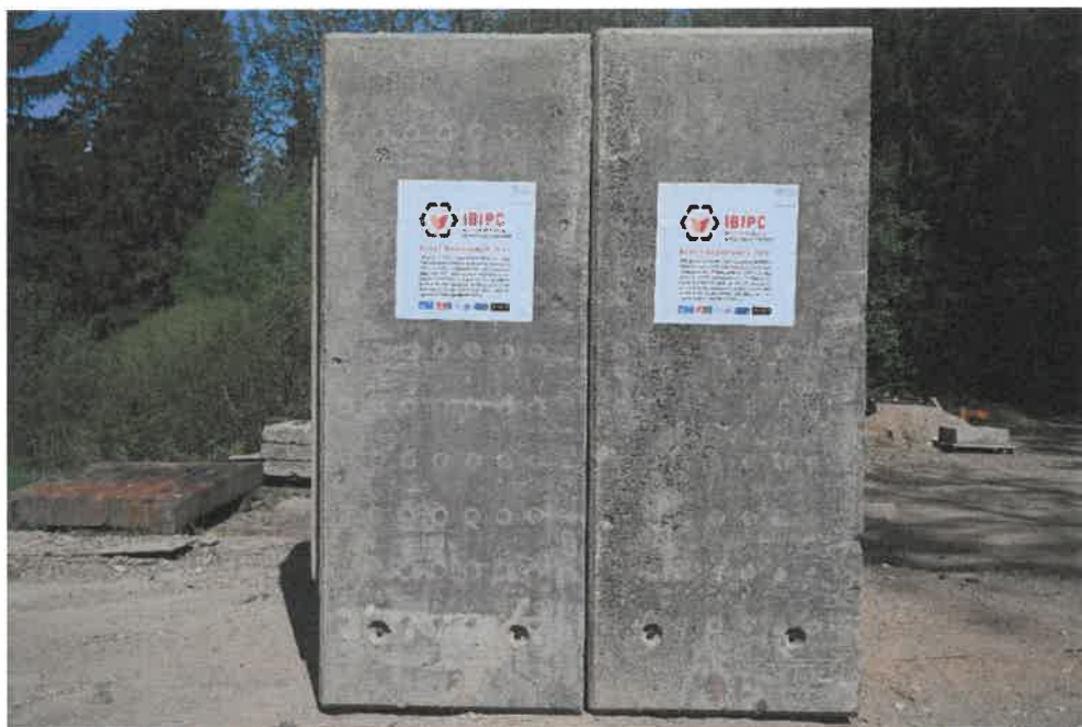
Obr. 3: Terč: UHPFRC základní díl bunkru 2000 x 2000 x 1000 mm, tloušťka stěny 200 mm – 2 ks Fig. 3: Target: UHPFRC basic part of the bunker 2000 x 2000 x 1000 mm, wall thickness 200 mm – 2 pcs
