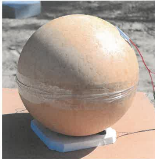
Obr. 2: Nálož 20 kg TNT Fig. 2: Blast charge 20 kg TNT
