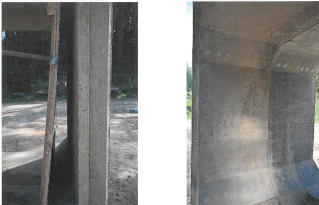
Obr. 5: Vlevo svědečný plech, vpravo zadní strana vzorku Fig. 5: Witness plate on the left, back of the sample on the right
