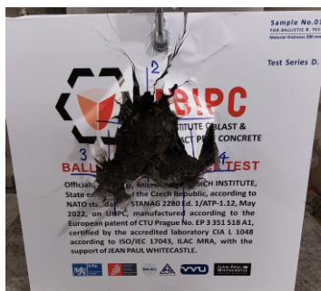
Pro sílu stěny 200 mm Balistická odolnost A5. Střepinová odolnost C4. Výbuchová odolnost D6.
