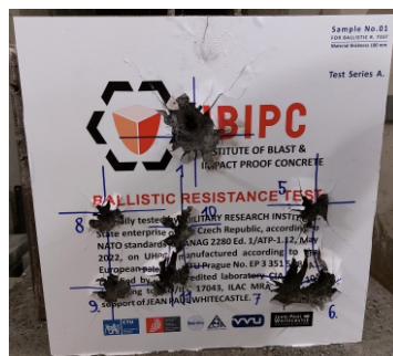
Pro sílu stěny 200 mm Balistická odolnost A5. Střepinová odolnost C4. Výbuchová odolnost D6.
