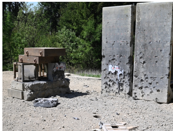
Pro sílu stěny 200 mm Balistická odolnost A5. Střepinová odolnost C4. Výbuchová odolnost D6.
