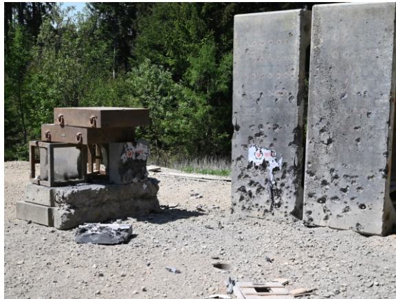
Pro sílu stěny 100 mm Balistická odolnost A3. Střepinová odolnost C4. Výbušková odolnost D6. Pro sílu stěny 200 mm Balistická odolnost A5. Střepinová odolnost C4. Výbušková odolnost D6.
