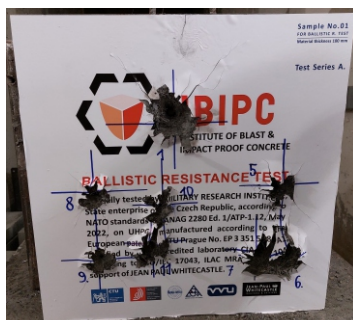
Pro sílu stěny 100 mm Balistická odolnost A3. Střepinová odolnost C4. Výbušková odolnost D6. Pro sílu stěny 200 mm Balistická odolnost A5. Střepinová odolnost C4. Výbušková odolnost D6.
