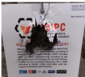
Pro sílu stěny 100 mm Balistická odolnost A3. Střepinová odolnost C4. Výbušková odolnost D6. Pro sílu stěny 200 mm Balistická odolnost A5. Střepinová odolnost C4. Výbušková odolnost D6.
